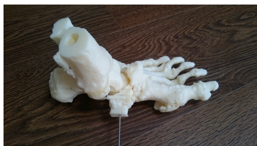
Figura 3.57 Aspectul final al modelului piciorului cu ghidajul aplicat.
