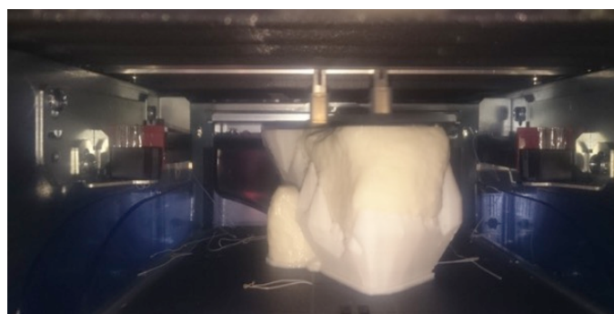
Fig.3.34 Fragmentul model aflat în zona de lucru a imprimantei
