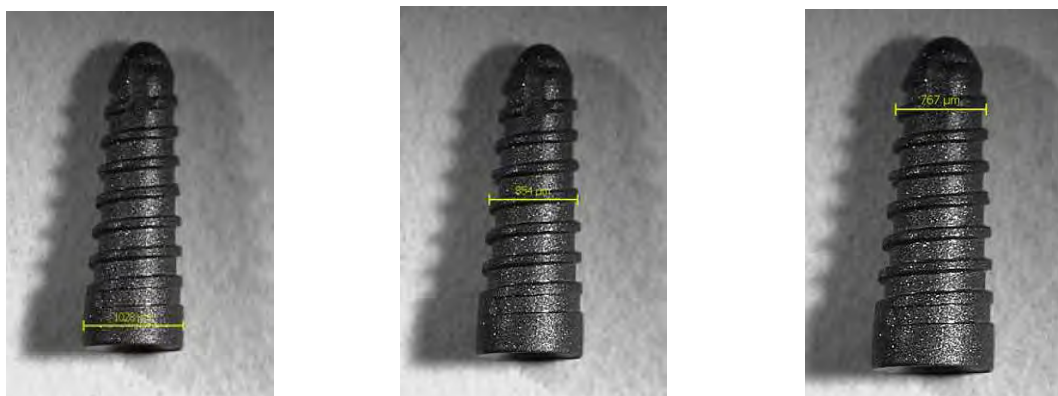
Fig.6.16. Caracteristici dimensionale ale filetului implantului din aliaj Ti10Zr tip șurub autofiletant (filet cu pasul 0,5mm)
