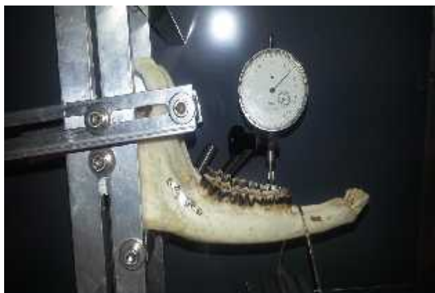
Mandibul instalat în dispozitivul de fixare
