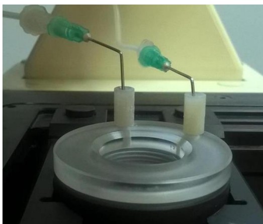
Figura 22 Dispozitiv de vizualizare și perfuzare sub microscop prototip, utilizat pentru înregistrarea imaginilor holografice și procedura de decuplare
