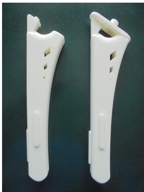
Fig. 22 Aspectul final al stemului proiectat, în urma procesului de tipărire cu ajutorul imprimantei 3D - FORMIGA P 110
