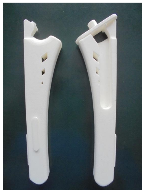
Fig. 22 Aspectul final al stemului proiectat, în urma procesului de tipărire cu ajutorul imprimantei 3D - FORMIGA P 110
