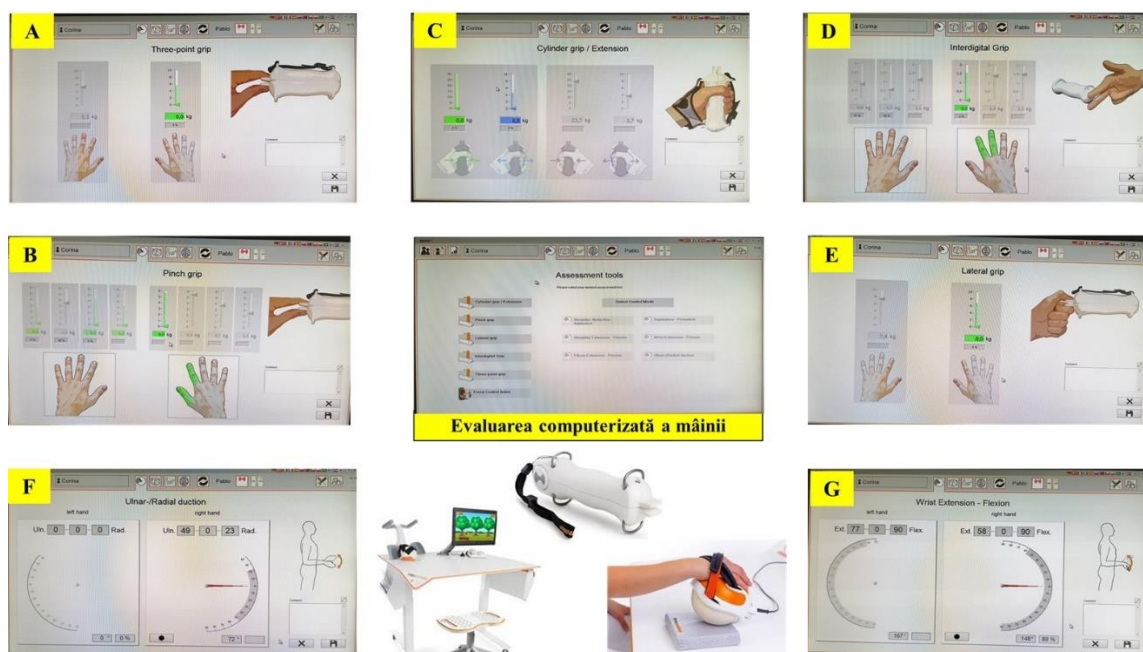
Fig. 6. Posibilități de evaluare a forței penselor și amplitudinii de mișcare la nivelul pumnului cu ajutorul dispozitivului robotic Pablo din dotarea CNCRNC
