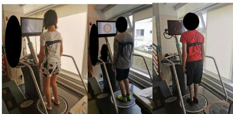
Fig. 3.1. (din cazuistica CNCRNC "Dr. Nicolae Robănescu" pe bază de consumjământ informăţ - adolescenţi cu PC - "Testarea probei Romberg" şi măsurarea "Indicelui de stabilitate globală (bazat pe echilibrare la joacă orizontală)", efectuate cu ajutorul Dispozitivului Avansat "PRO-KIN 252"
