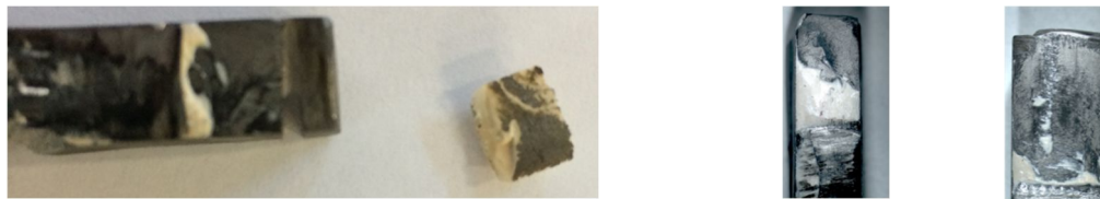
Fig. 4.6 – Aspectul probelor testate după cedarea legăturii metalo-ceramică.
