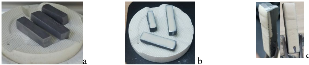
Fig. 4.4 – Aspectul tijelor din aliaj experimental: a) la terminarea programului de oxidare, b) după aplicarea stratului de opac, c) după aplicarea primelor straturi de ceramică
