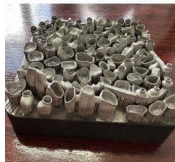
Figura 6.1. Pini de atașare a restaurărilor pe platforma imprimantei 3D pentru metal (arhiva personală)
