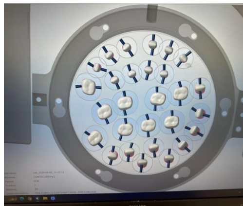
Figura 6.2. Fișiere STL ordonate digital în discul de oxid de zirconiu (arhiva personală)
