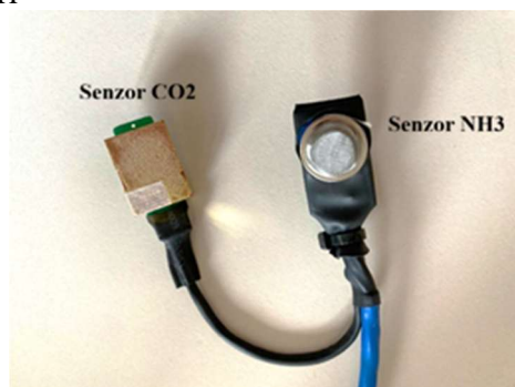
Senzori utilizați: CO 2 (Model: MH-Z19B și Model MH-Z19C v. www.winsen-sensor.com ) și NH 3 (Model: MH-Z19C v. www.winsen-sensor.com ) și NH 3 (Model: MH-Z19C v. hwsensor.com )
