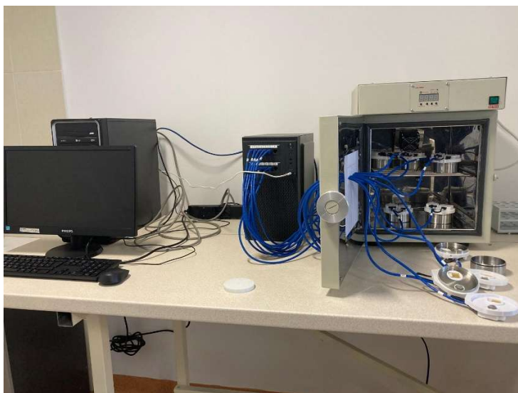
Computer, unitate de achiziție a datelor, incubator cu recipiente aflate în diferite stadii de asamblare a senzorilor
