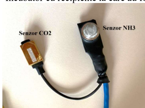
Senzori utilizați: CO 2 (Model: MH-Z19B și Model MH-Z19C v. www.winsen-sensor.com ) și NH 3 (Model: MH-Z19C v. www.winsen-sensor.com ) și NH 3 (Model: MH-Z19C v. hwsensor.com )
