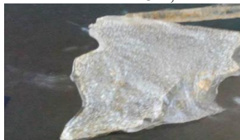
Fig.V.22 Peliculă din collagen de chefal pește cu Zn Cl2 3%
